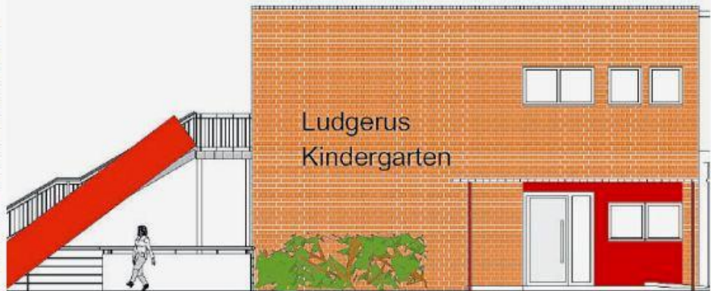
Neugestaltet wird der Eingangsbereich der künftigen DRK-Kita im Westflügel der Ludgerusschule. Vom Fluchtbalkon aus dem Obergeschoss wird außerdem eine Rutsche neben der Treppe ins Außengelände führen.
